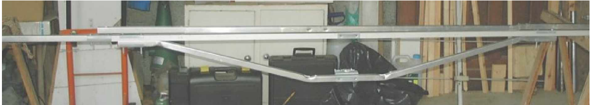
Renfort d'origine Tonna, le morceau de boom d'origine dessus à supprimer, et la barre de 3 mètres.
